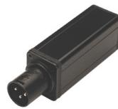
Symmetrierer Line XLR male / Cinch female, 1:1 Uebertragung für Signale mit 600 Ohm-Impedanz, Line bis 6 V mit dem Frequenzgang von 30Hz-40KHz. Die umgewandelten Signale werden durch den internen Uebertrager NTL1 zusätzlich galvanisch getrennt.
