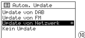
Die aktuelle Einstellung ist mit dem Stern \* gekennzeichnet (automatische Zeitsynchronisation über das Internet). Weitere Optionen sind: Automatische Zeitsynchronisation über DAB-Sender oder UKW-Sender (FM) oder manuelle Zeiteinstellung (Kein Update).
