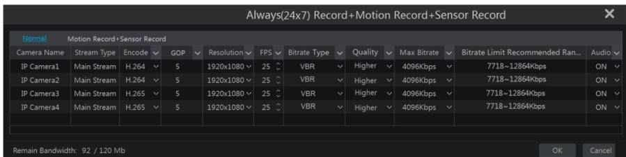
**Video Encode:** Format für die Videokomprimierung; sofern die Kamera „H.265“ unterstützt, stehen die Optionen „H.265“ und „H.264“ zur Verfügung; anderenfalls wird nur die Option „H.264“ angeboten.
