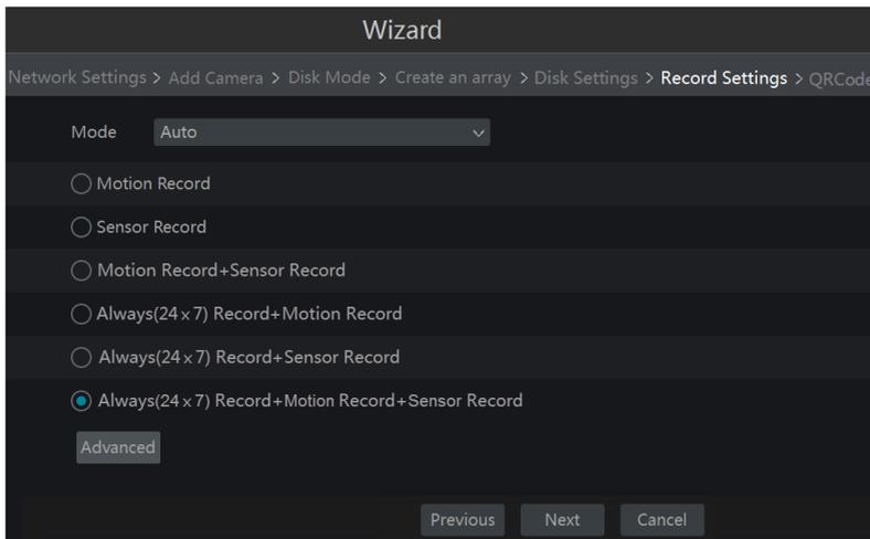
**Manual:** Für jede Kamera die Werte für „Sensor Record“, „Motion Record“ und „Schedule Record“ auswählen. Mit „OK“ die Einstellungen speichern. Siehe Kapitel 7.1.1, „Modus-Konfiguration“.
